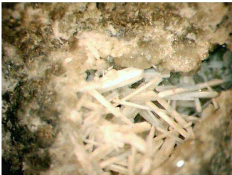
A digitális mikroszkóppal készített felvétel a Gyombola Gábor által Pomázon gyűjtött zárvány egyik részletét ábrázolja, a képkivágás mérete 15x10 mm (piroxén vagy wollastonit utáni opál-álalak)
