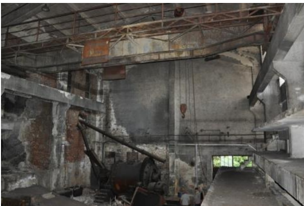
Malomcsarnok függődaruval, golyósmalommal
