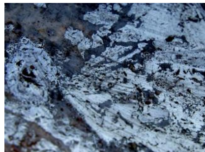
Fonalas és gömbös hematit a csziszolt mintában, ami sugálja a biogén eredetét
