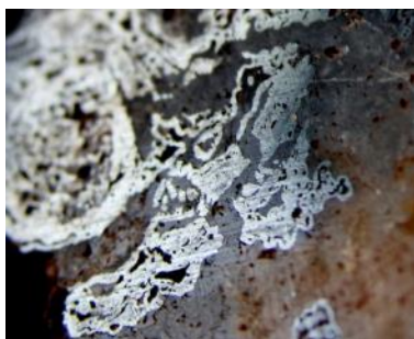
Fonalas és gömbös hematit a csziszolt mintában, ami sugálja a biogén eredetét
