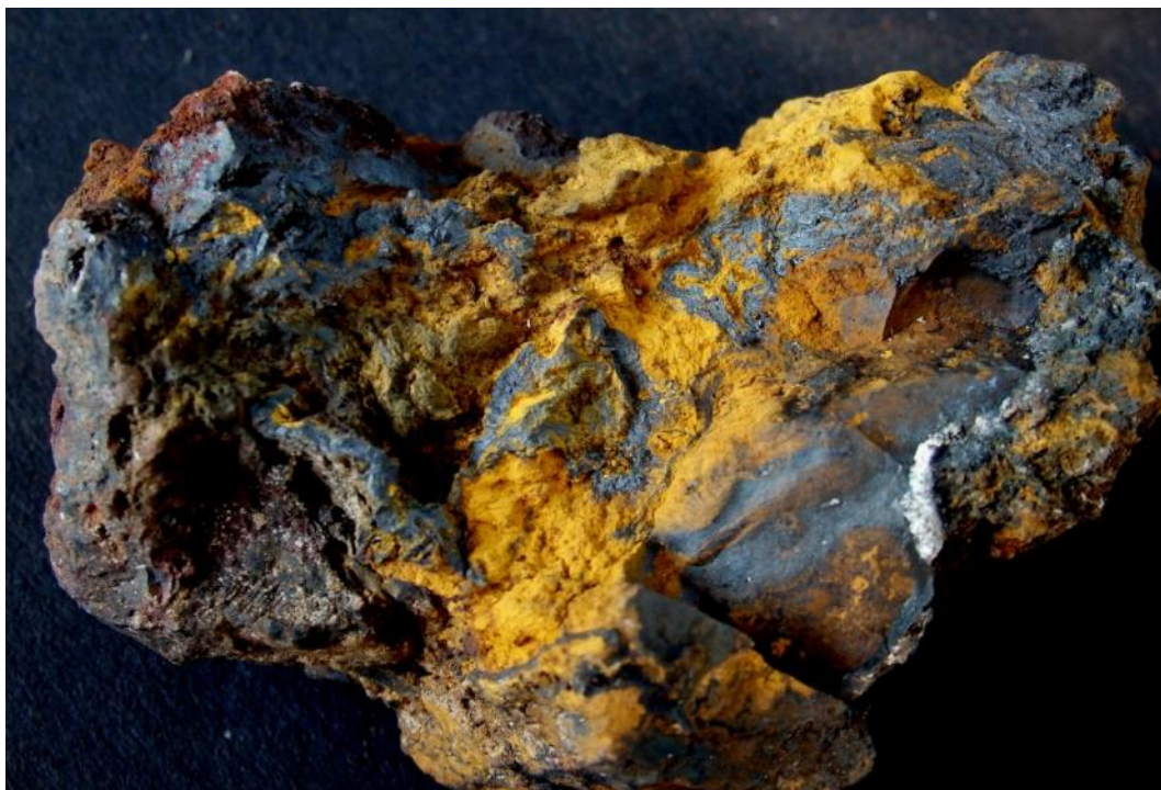
Tipikus „bátori-s” vasérc (limonit és hematit)- ehhez hasonló a János-hegyi Átjáró barlang aknája mentén is találunk, ahol szintén bányásztak vasércet (Vajna, 1973)
