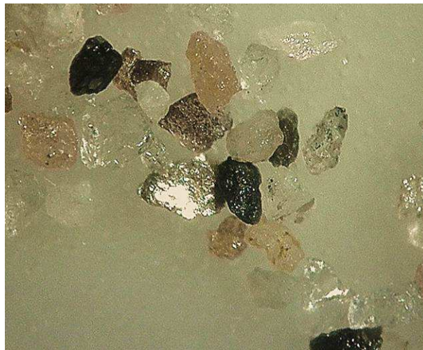
Termésaranylemezek a mosással készített dúsítmányban , ezek 0,1-0,4 mm-esek
