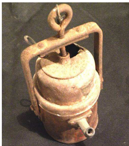
Ilyen karbidlámpát használták a bányászok – még most is keresett eszköz veszélyes tárokból, mert jelzi a levegő fogyását
