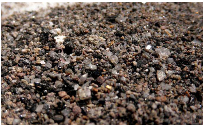
Nehézasvány-dúsítmány az őrlőiszapból egy db arany szemcsével és sok ezüstszárvánnyal
